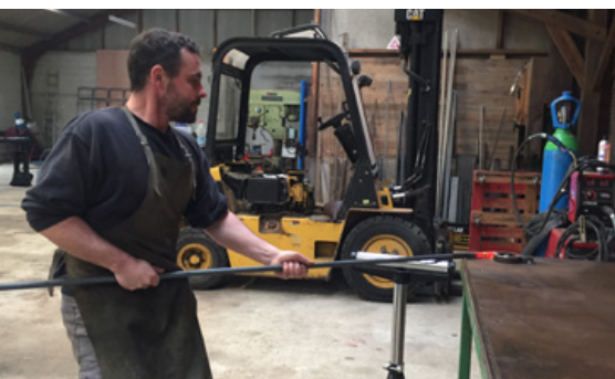
Mathieu Cabioch, artisan d'art effectue un cintrage à chaud pour la réalisation d'un portail.
